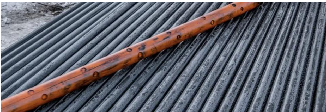
Фиг. 8. Перфорационна тръба с разположение на зарядите
