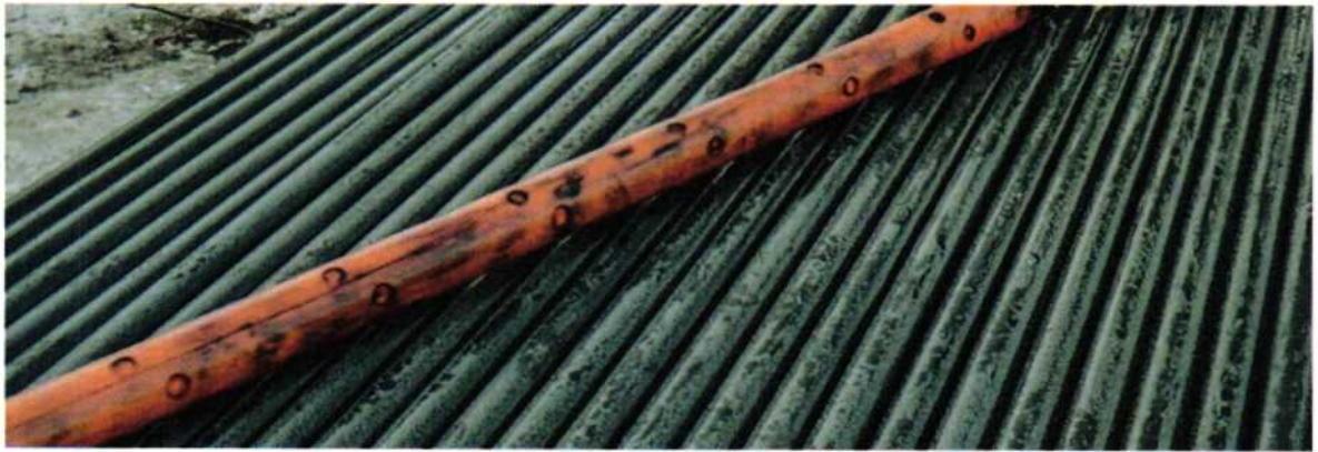
Фиг. 9. Перфорационна тръба с разположение на зарядите
